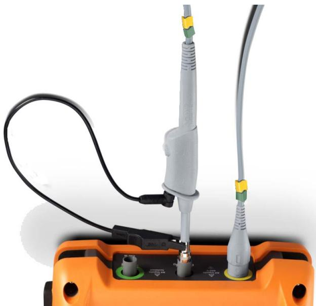
使用非金屬工具調整探頭上的修整電容，使脈波盡可能平坦。
